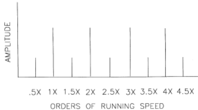
Fig. 5.7: Espectro de un equipo con soltura, notar la presencia de subarmónicos de la velocidad de giro
