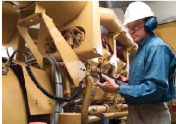
Fig. 2.14 Medición en terreno de un equipo con un recolector de vibración
