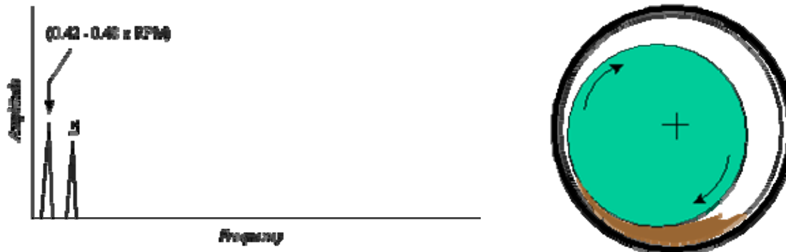
Fig. 5.35: Espectro esperado para el oil whirl y un esquema de las inestabilidades que se producen al interior del descanso
